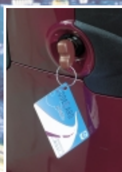
Strumentazione chiara e completa, di elegante design, comprende anche un led che segnala l'attivazione del sistema antifurto. L'immobilizer consente l'accensione del motore solo se identifica il codice della chiave.
