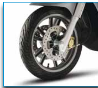
Grande capacità frenante grazie al doppio disco anteriore.
